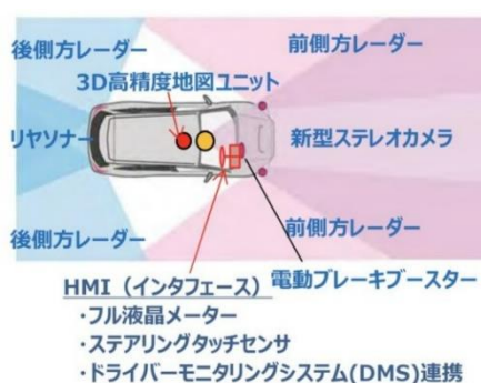
図 1.2 安全運転支援システム (出典：スバル Eyesight X)
